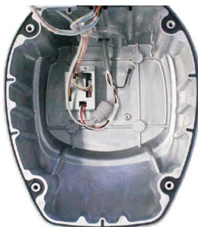
7. Закройте крышку антенны, проверьте влагозащитный уплотнитель.
